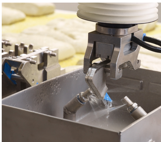
Système de nettoyage et humidification automatique des couteaux
