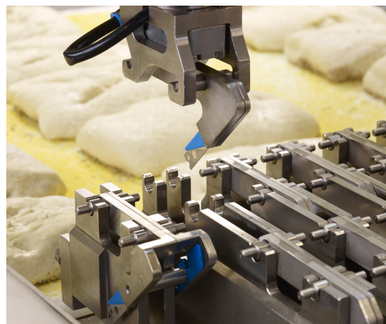
Changement automatique de couteaux (10 pièces) Bloc de couteaux interchangeable Différents type de couteaux disponibles
